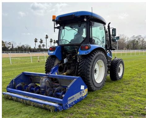
Décompactage du terrain
